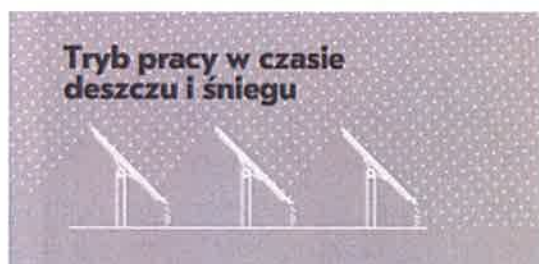
Obrót do najbliższego maksymalnego kąta; automatyczne mycie w celu zwiększenia wydajności oraz odsnieżanie modułów w celu redukcji obciążenia.
