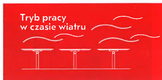
Adaptacja położenia modułów na podstawie prędkości wiatru.
